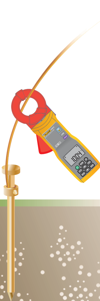
Aufbau für spießloses Messverfahren mit der Erdschleifenmesszange 1630-2 FC.
