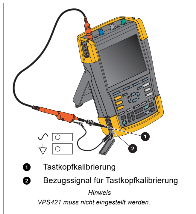
Abbildung 48. Einstellung des Spannungstastkopfes
