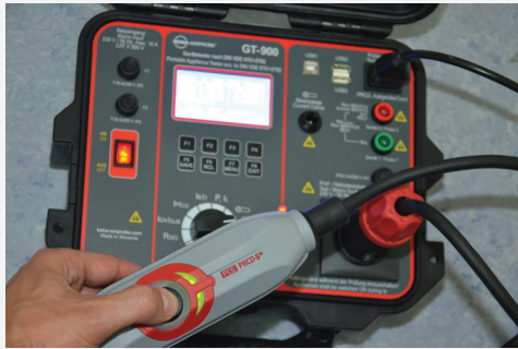
Prüfung von ortsveränderlichen Fehlerstrom-Schutzschaltern (PRCD, PRCD-S, PRCD-S+, PRCD-K)
