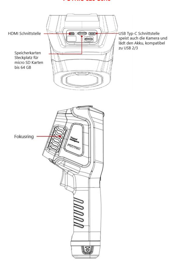
Der Fokusring ist bei der Typenreihe mit Endung "F" wie "Festfokus" nicht vorhanden, die Kameraoptik liefert scharfe Bilder ab einer Distanz von 0.5 m zum Ziel, näher sind die Bilder Unscharf und die Messwerte falsch.
