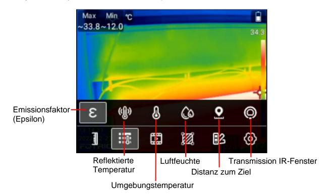
Die Werte für Umgebungstemperatur, Luftfeuchte sowie Distanz zum Ziel müssen in der Praxis nicht verstellt werden (Einfluss auf Messwerte zu gering), Die Transmission muss nur bei Messungen durch spezielle IR-Fenster eingestellt werden.
