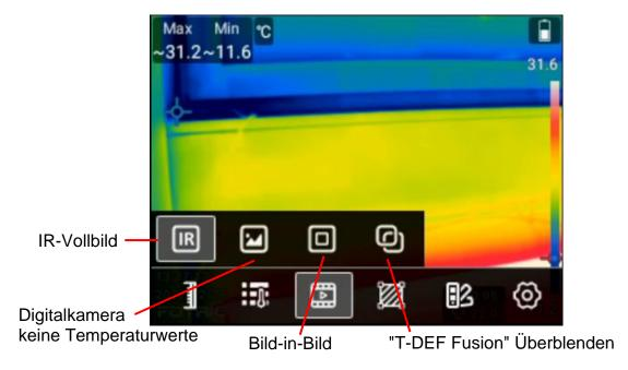
Bei Bild-in-Bild kann durch Antippen in der Mitte des IR-Bildausschnittes die IR-Fenstergrösse an den Eckmarkierungen verändert und der Ausschnitt mit der Mittelmarkierung verschoben werden. Mit Zurücktaste die Bildänderung bestätigen. In der Fusion / Überblenden-Ansicht kann mit dem Einstellrad auf dem Bildschirm oder den Navigationstasten links/rechts die Transparenz des IR-Bildes eingestellt werden.
