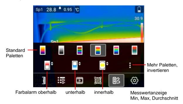
Farbalarme färben Temperaturbereiche oberhalb, unterhalb innerhalb eines anzugebenden Temperaturbereiches in rot, blau oder gelb ein. Das Bild wird in grau dargestellt und mit der Alarmfarbe überlagert. Um den Alarmwert einzustellen, muss der jeweilige Grenzwert (oben rechts im Display bei aktivierter Alarm Palette) blau hinterlegt sein, ist dieser weiss darauf tippen und mit den Navigationstasten auf/ab den Wert einstellen.
