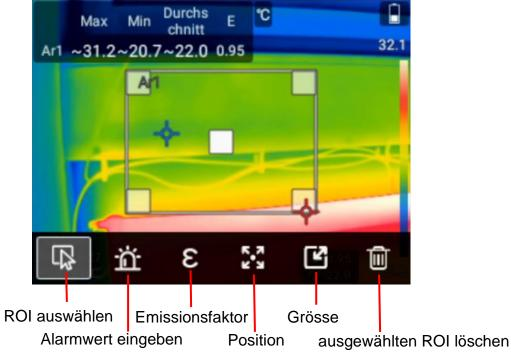
Für Alarm kann pro ROI ein H / L (hoch, rot / tief, blau) Temperaturalarm definiert werden und den Alarm stumm mit roter (H) oder blauer (L) Schrift und blinkender Glocke daneben oder akustisch ausgegeben werden.
