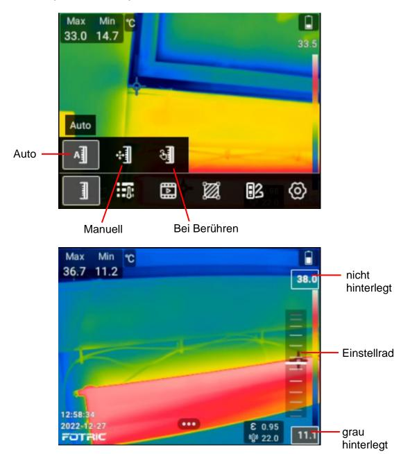
Für manuelle Temperatureingabe das "Einstellrad" im Bildschirm rechts aussen neben der Farbpalette nach oben oder unten schieben oder Navigationstasten auf / ab benutzen. Es wird nur der "dunkelgrau" hinterlegte Werte (im Bild oben der untere Skalenwert) verändert, der nicht markierte bleibt fest. Um die Skalenwerte zu aktivieren / deaktivieren diese antippen oder mit Navigationstasten links / rechts selektieren.
