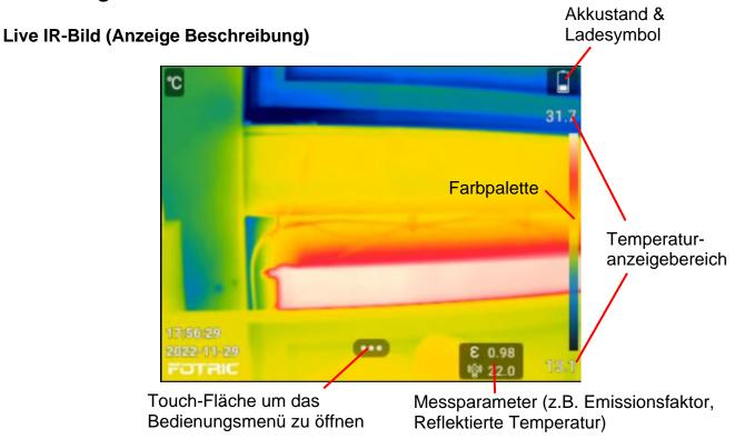
Die Kamera hat keine automatische Ausschaltfunktion, der Bildschirm wird nach einer in den Geräteeinstellungen voreingestellten Zeit ausgeschaltet (auch deaktivierbar), die Kamera läuft dabei weiter.
