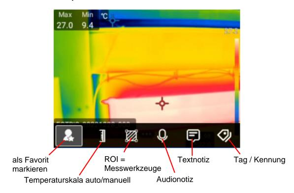
Für die Funktion "Tag / Kennung" kann ein Standard QR-Code direkt mit der Digitalkamera gescannt und eingelesen oder manuell eingegeben werden. Der Tag ist üblicherweise eine Standortbezeichnung oder Inventarnummer.
