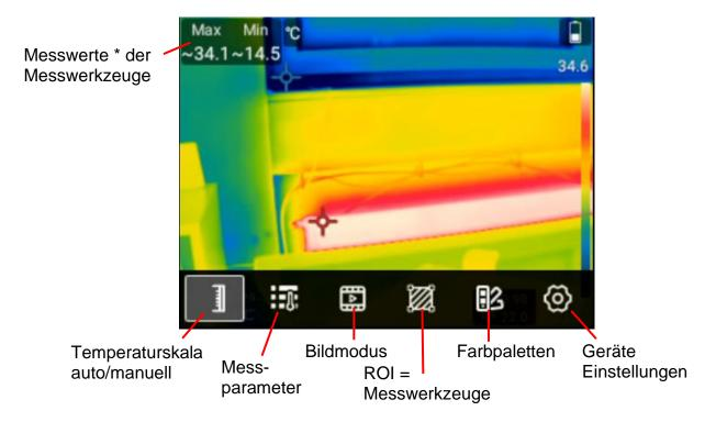
Generell bedient man die Kamera entweder über den Touchscreen oder über die Navigationstasten oben/unten/links/rechts und der darin mittig gelegenen "OK" bzw. "Enter" Taste.
