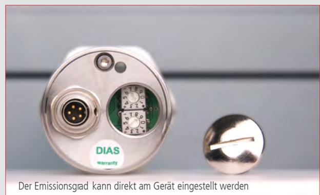
Der Emissionsgrad kann direkt am Gerät eingestellt werden
