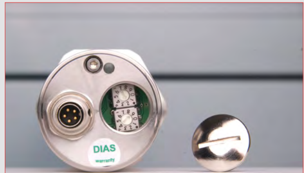
Der Emissionsgrad kann direkt am Gerät eingestellt werden
