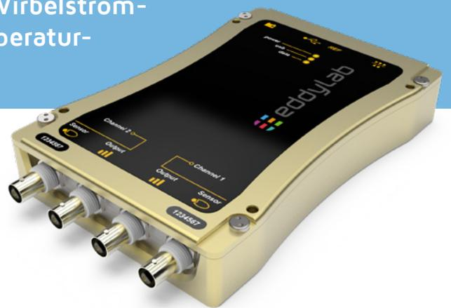
Seit über 10 Jahren befassen wir uns mit der Entwicklung und Herstellung hochwertiger Wirbelstromsensoren für Industrie und Forschung. Mit der Einführung der TX-Serie ist es eddylab gelungen, dem Markt erstmalig ein voll digitales Gerät mit CAN-Interface, USB-Interface und analogem Signalausgang anzubieten, ohne dabei auf die hohen dynamischen Eigenschaften von Analoggeräten zu verzichten.
