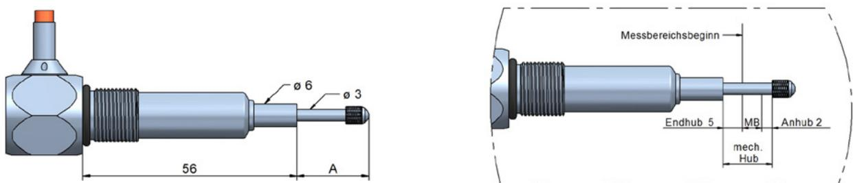
Bitte beachten Sie, dass der angegebene Anhub und Endhub (siehe Kreis) Richtwerte sind. Bei Kalibrierung des Sensors vor Auslieferung wird auf bestmögliche Linearität geachtet.
