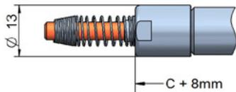
Geräte mit Kabelausgang sind mit einer Kabelverschraubung zur Zugentlastung und einer Knickschutzfeder ausgestattet.
