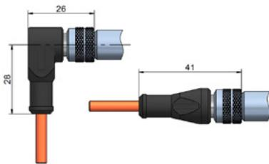
Für Geräte mit Steckeranschluss muss das Kabel gesondert bestellt werden. Hierbei stehen Kabel mit geradem Stecker oder mit Winkelstecker zur Verfügung.
