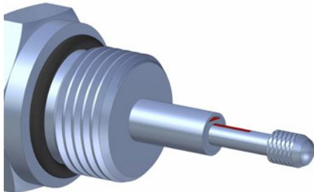
Die Option VH sollte gewählt werden, wenn der Sensor in Flüssigkeiten (Öl, Wasser, ...) betrieben wird oder mit schnellen Druckschwankungen zu rechnen ist. Durch die Planflächen (siehe Bild: rot markierte Flächen) auf den Mechanikteilen des Sensors wird der Druckausgleich bzw. die „Belüftung“ innerhalb des Sensors erleichtert.
