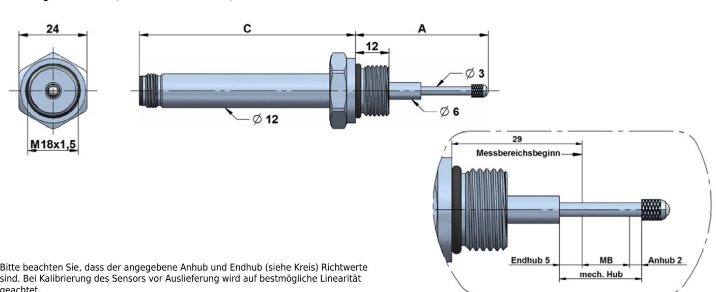
Bitte beachten Sie, dass der angegebene Anhub und Endhub (siehe Kreis) Richtwerte sind. Bei Kalibrierung des Sensors vor Auslieferung wird auf bestmögliche Linearität geachtet.
