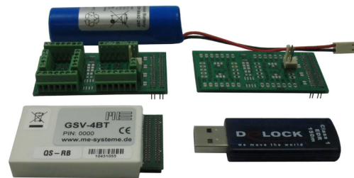
Abbildung 2: GSV-4BT und Zubehör (Akku, Adapter- Leiterplatte, BT-USB Stick)
