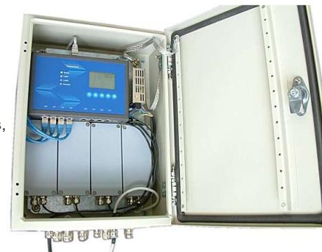
Die Häufigkeit der Messung (Datenrate) ist in einem weiten Bereich konfigurierbar, z.B. alle 10 Sekunden für die Siloüberwachung oder ereignisgesteuert mit 1000 Messwerten pro Sekunde über 8 Messkanäle gleichzeitig für die Maschinenüberwachung (Abtastrate 10.000 Samples/Kanal)
