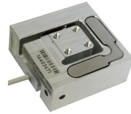
Der 3-Achs Sensor K3D40 eignet sich für die Kraftmessung in drei zueinander senkrechten Achsen. Er ist verfügbar für ±2N, ±10N, ±20N und ±50N in allen drei Achsen, und kann optional in anderen Messbereichen gefertigt werden. Er zeichnet sich durch eine besonders kompakte Bauform mit einer Grundfläche von 40mm x 40mm und einer geringen Bauhöhe von 20mm aus.
