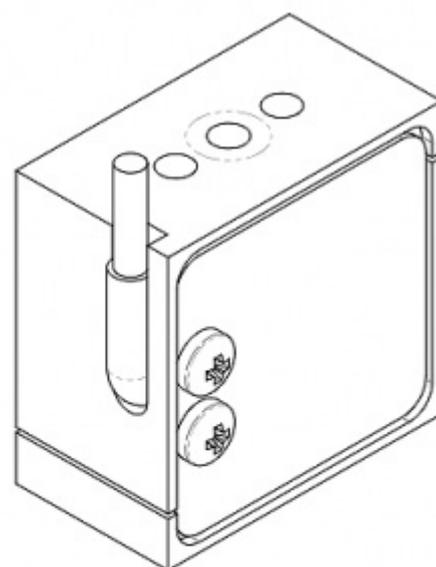
Variante mit Kabel vertikal
