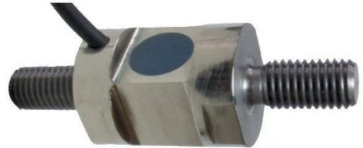
Der Kraftsensor KM30z ist ein Zug-/Druck-Kraftsensor mit kompakten Abmessungen. Für die Kräfteinleitung sind zwei Gewinde vorgesehen: M12 Regelgewinde bis 10kN, M16 Regelgewinde für M20kN, M20 Regelgewinde ab 50kN. Die Ausführung bis 2kN sind aus Aluminium-Legierung. Als Zubehör stehen Ringmutter zur Verfügung.
