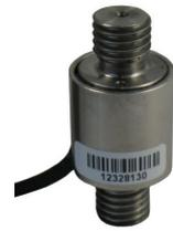
Der Kraftsensor KM16z ist ein Miniatur Zug-Druckkraftsensor mit kleinen Abmessungen, der zur Messung von Zug und Druckkräften eingesetzt wird. Für die Krafteinleitung sind zwei Gewinde vorgesehen. Die Schutzart ist IP67. Die Krafteinleitung muss frei von Querkräften und Biegemomenten erfolgen.
