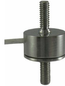
Der KM10z ist ein Membran-Kraftsensor in Ultraminiatur-Ausführung für Zug- und Druckkraft-Messung. Die Krafteinleitung erfolgt über zwei Gewinde M2,5. Bei der Krafteinleitung muss sichergestellt werden, dass keine Biegemomente größer als 0,1 Nm eingeleitet werden.
