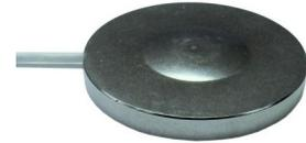
Der Kraftsensor KM25 ist ein Membran-Kraftsensor mit kleinen Abmessungen. Er eignet sich zur Messung von Druckkräften. Der Kraftsensor wird in eine Flachsenkung eingepasst und gegebenenfalls mit Klebstoff fixiert. Für die Kraffteinleitung ist eine Kalotte mit Radius 20 mm vorgesehen. Die Schutzart ist IP 66.
