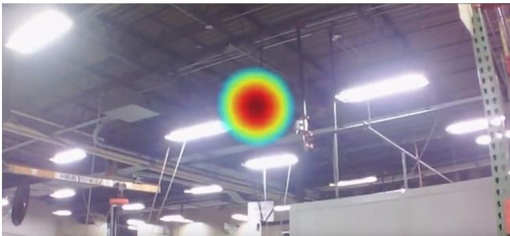
Die bereits bekannten Methoden der Leckortung mittels speziellen Ultraschall-Empfängern mit einem Mikrofon oder auch die Inspektion der Anlagen mit dem blossen Gehör wenn der Betrieb still steht sind im Vergleich zur Ortung mit der Schallkamera sehr ineffizient und teils nur durch erfahrene Inspektoren zu bewerkstelligen. In vielen Fällen herrscht zudem 24/7 Betrieb, eine Leckortung durch
