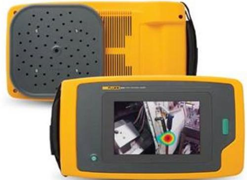
Die Schallkamera funktioniert auch in lärmiger Umgebung da diese mit Filtern die Umgebungsgeräusche bestmöglich ausfiltert und auf die Leckagen "fokussiert".
