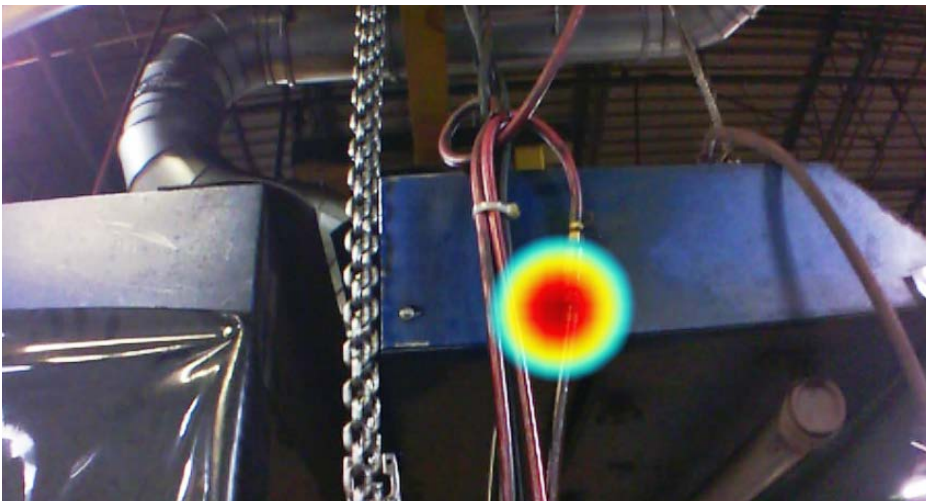
Abbildung der Industrie-Schallkamera ii900 bei der Erkennung eines Luftlecks in einer industriellen Umgebung.
