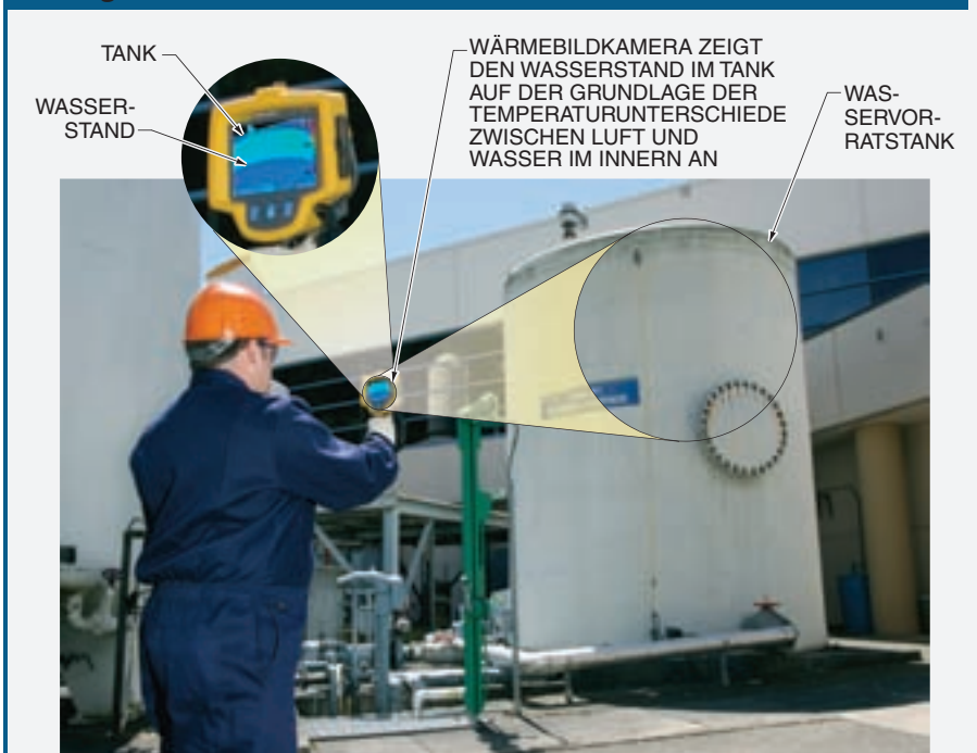
Abbildung 6-4. Eine häufige Anwendung der Thermografie ist die Bestimmung bzw. Bestätigung der Füllstände von verschiedenen Stoffen in Behältern, z. B. in Vorrattanks und Silos.
