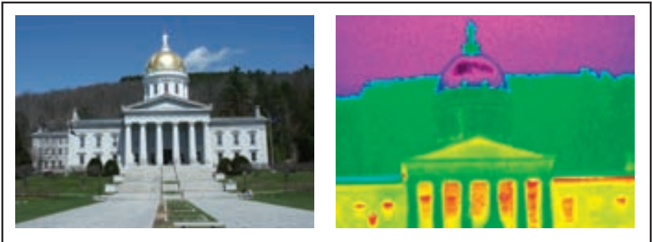
Abbildung 5-73. Der vergoldete Dom eines Regierungsgebäudes reflektiert den relativ kalten Himmel.
