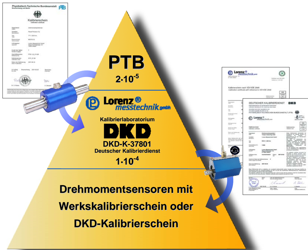
Bild 2: Ununterbrochene Messkette von Vergleichen von der PTB bis zum ausgelieferten Sensor
