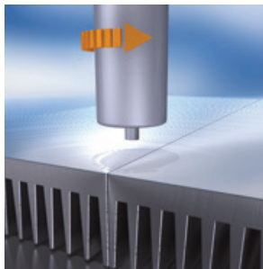
Schweißwerkzeug wird in Rotation versetzt
