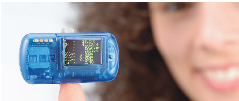
**Funk-Datenlogger zur Überwachung von Temperatur, Feuchte, Luftdruck, Flüssigkeitsdruck, Licht, 3-Achsen-Beschleunigung, Dehnungsmessstreifen u.v.m.**
