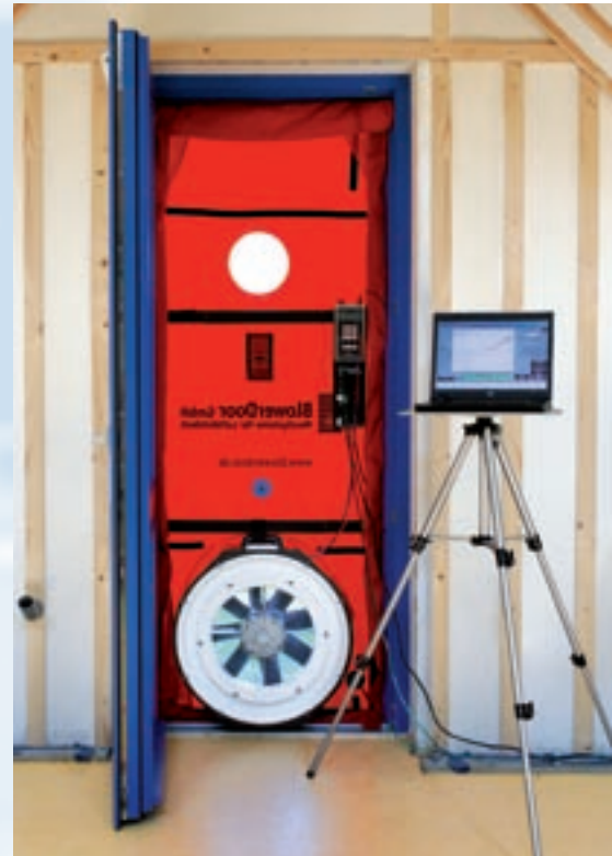
Marktführend: Die Minneapolis BlowerDoor mit einem Messbereich von 19–7.200 m 3 /h
