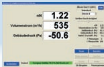
Die automatische BlowerDoor-Messung mit der Software TECTITE Express
