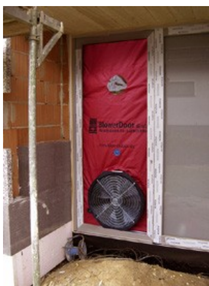
Mesures avec BlowerDoor dans un bâtiment neuf
