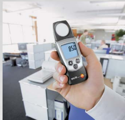
Messung der Beleuchtungsstärke an Arbeitsplätzen
